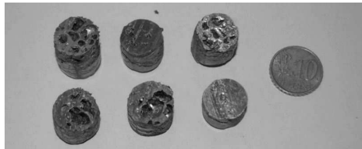
Fig.2 - Esempi di alcune schiume di Al da sottoporre a prova di compressione / Examples of Al foams for the compression test.
