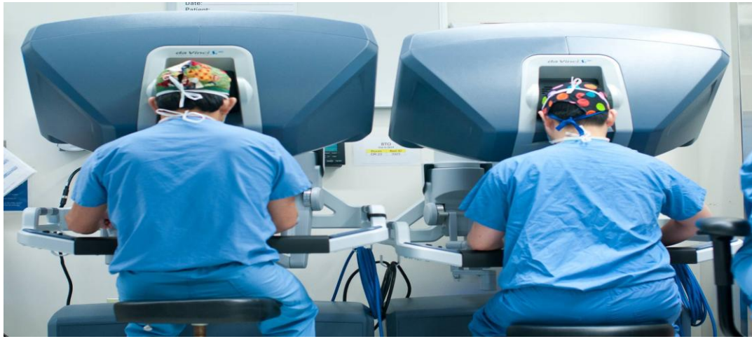
FIGURA 15: Una seconda console opzionale consente a due chirurghi di collaborare durante una procedura
