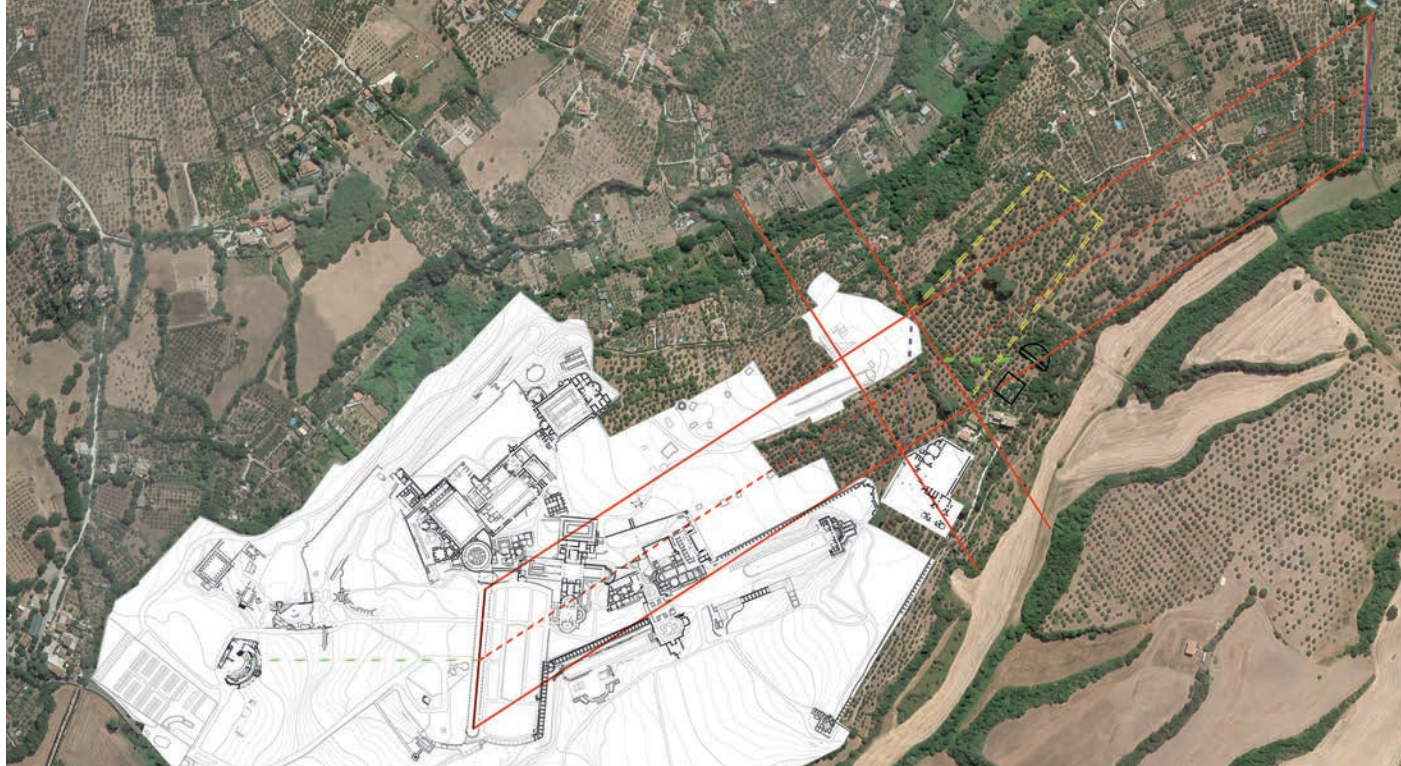
Fig. 20. Inserimento della pianta del 2018 sulla foto aerea, con evidenza della posizione, del parallelismo e delle dimensioni dei due muri pertinenti le due porticus di accesso alla Villa. Le linee rosse continue indicano gli allineamenti dei limiti di entrambi i muri; la linea rossa tratteggiata segnala l'asse mediano; le linee rosse trasversali indicano i limiti della porzione centrale tra i due muri, all'incirca coincidente con uno dei bracci viari del cd Grande Trapezio (giallo tratteggiato); le linee verdi a tratteggio suggeriscono gli allineamenti tra l'asse centrale e i centri dei due teatri della Villa
