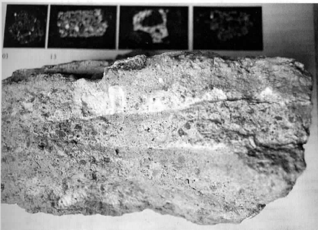
fig. 27 – Campione della malta nel bacino US 415 costituito da tre fasi di utilizzo.
