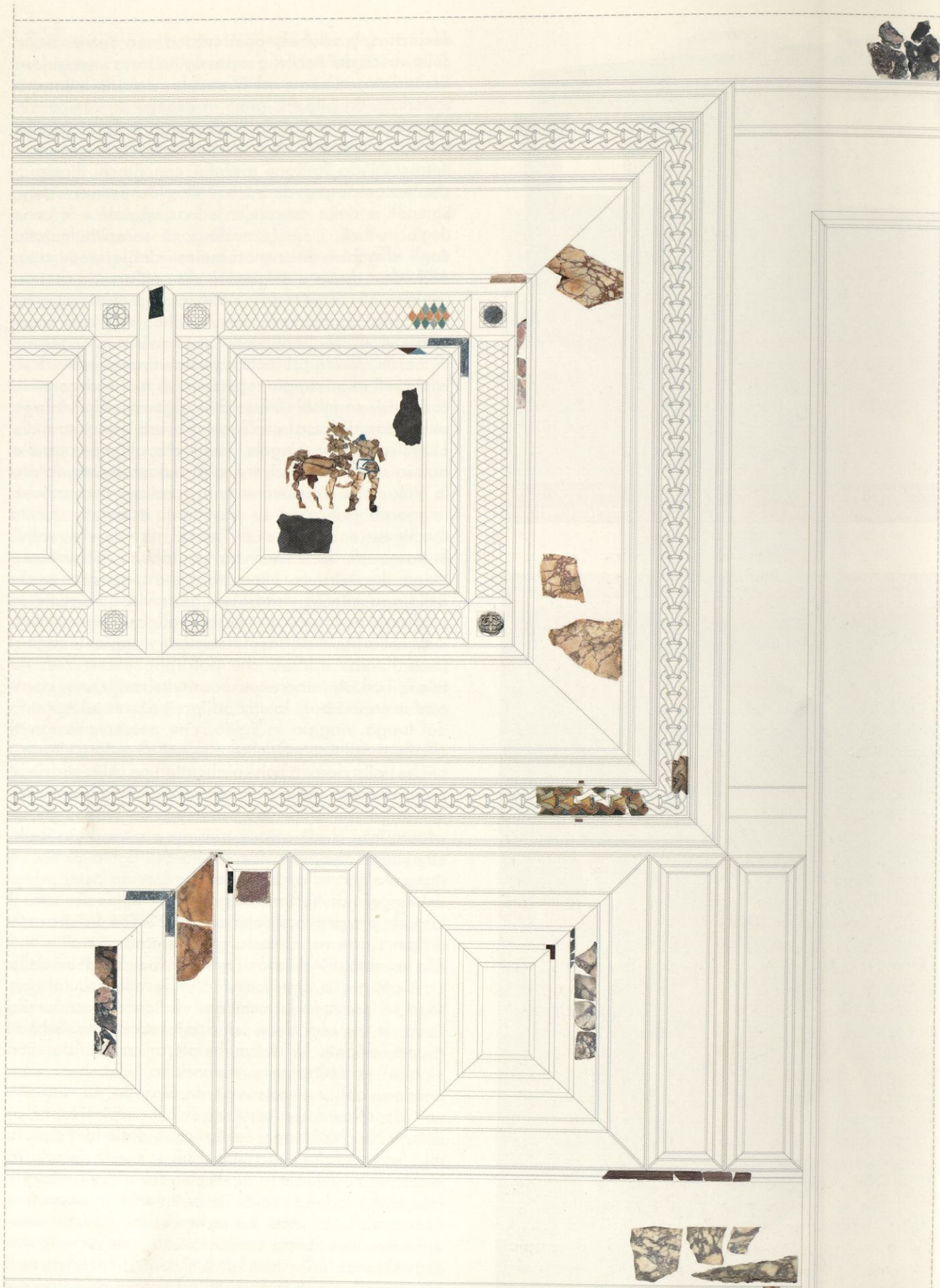
Ipotesi di ricostruzione dello schema compositivo di una parete dell'Edificio con Tre Esedre sulla base della disposizione dei fori per le grappe di fissaggio delle lastre marmoree e ricollocazione in situ di alcuni frammenti rinvenuti nello scavo dell'ambiente (B. Ademeri, G.E. Cinque)
