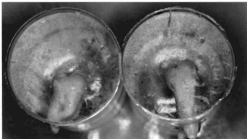
Figg. 23 e 24 Denti inglobati in resina epossidica
