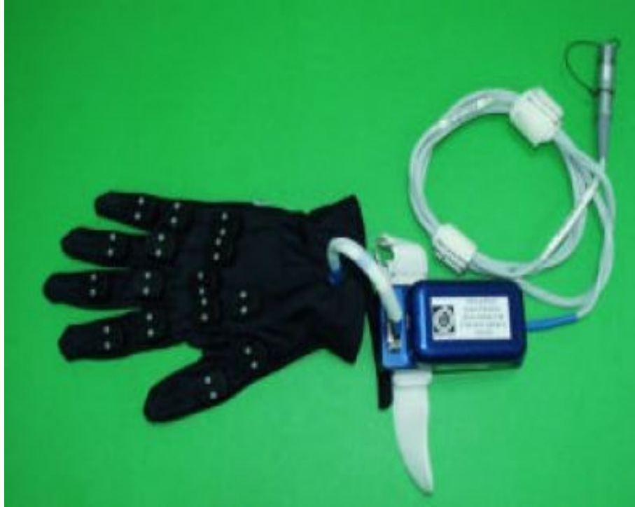
fig 8 - Guanto strumentato e box di misura inerziale del sistema HPA.
