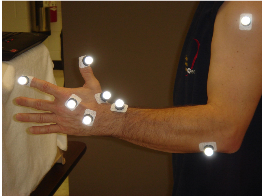
fig 12 - setup dei markers su di un soggetto ELITE-S2.
