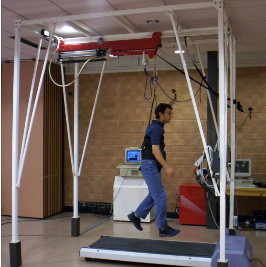
Camminare in aria è possibile! Il sistema di sgravio del peso corporeo in funzione.
