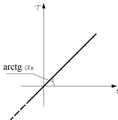
**Figura A3.1** – Strato di adesivo indefinitamente elastico lineare.
