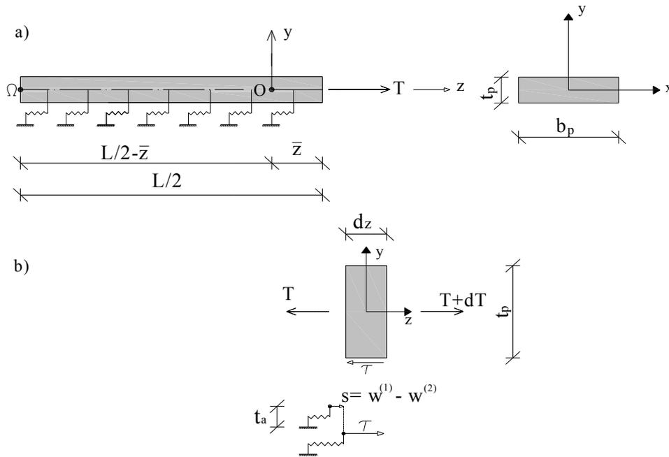
**Figura A3.2** – a) Schema ausiliario con sistema di riferimento; b) Tronco elementare.
