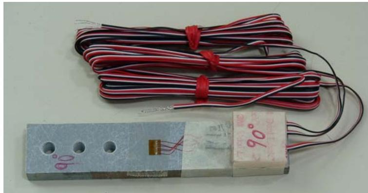
**Figura 3.8** – Provino di GFRP per la prova di compressione.
