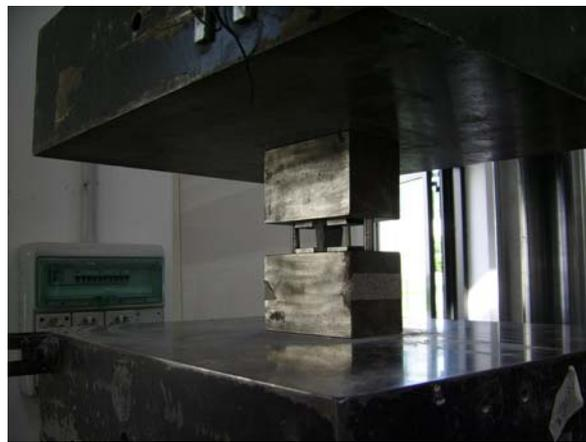
**Figura 3.7** – Dispositivo di prova inserito tra le ganascе della macchina universale.
