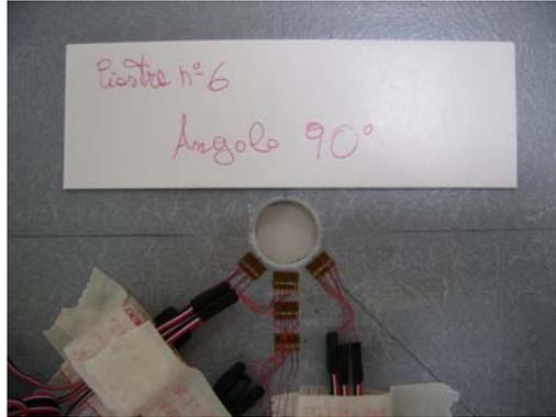
**Figura 8.9** – Disposizione trasduttori nell'intorno del foro centrale del piatto di GFRP.
