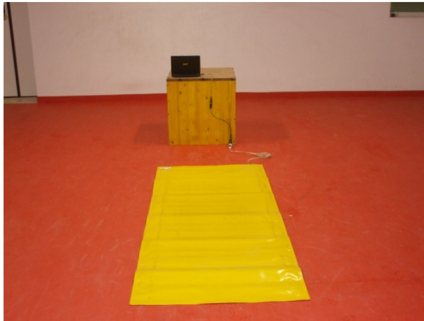
Figura 5 – Ergo Jump Bosco System per l'analisi dei parametri di Altezza di salto (cm), Tempi di contatto (ms) e Potenza espressa (watt).
