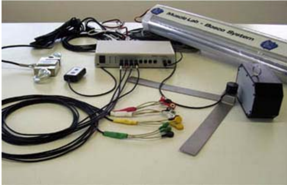
Figura 2 - Elettromiografo Muscle Lab Bosco System 4000e per la valutazione dell'attività elettrica muscolare.
