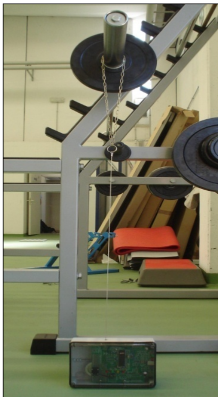
Figura 3 – Ergo speed: encoder lineare per la misurazione dei parametri cinematici spazio, durata e velocità.
