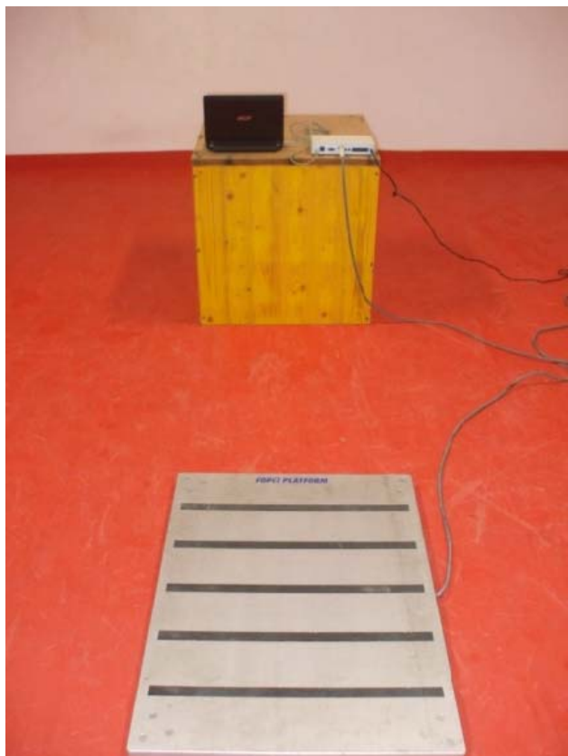
Figura 1 - Force Platform Muscle Lab Bosco System 4000e per la valutazione della forza espressa al terreno.
