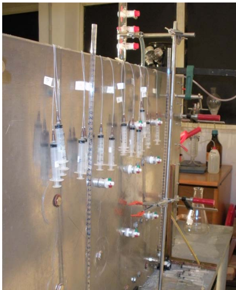
Figura 6.6: Vista della parete posteriore dell'apparato sperimentale e sistema di campionamento
