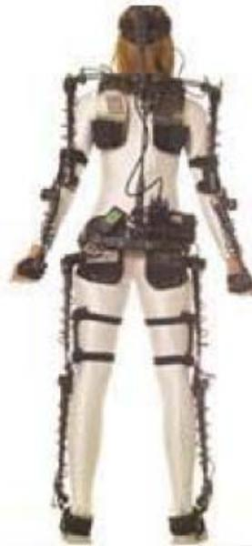
**Figura 1.2.9. Esempio di dispositivo di tracking meccanico, Gypsy 4.**
