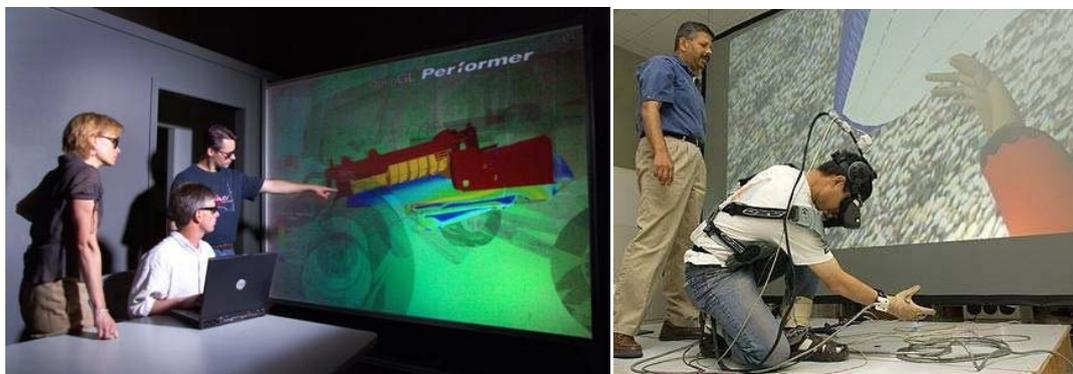
**Figura 3.1.2. Esempi di Virtual Engineering. A sinistra, interazione visiva con ambiente virtuale. A destra, un esempio di interazione visiva e tattile con l'ambiente virtuale attraverso dispositivi d'interfaccia indossati dall'operatore.**
