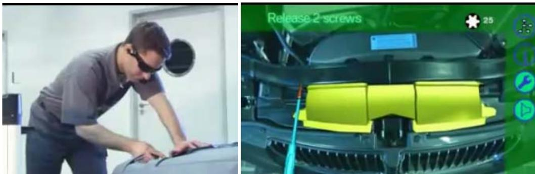
**Figura 1.2.15. Applicazione di Realtà Aumentata per le operazioni di manutenzione e riparazione.**
