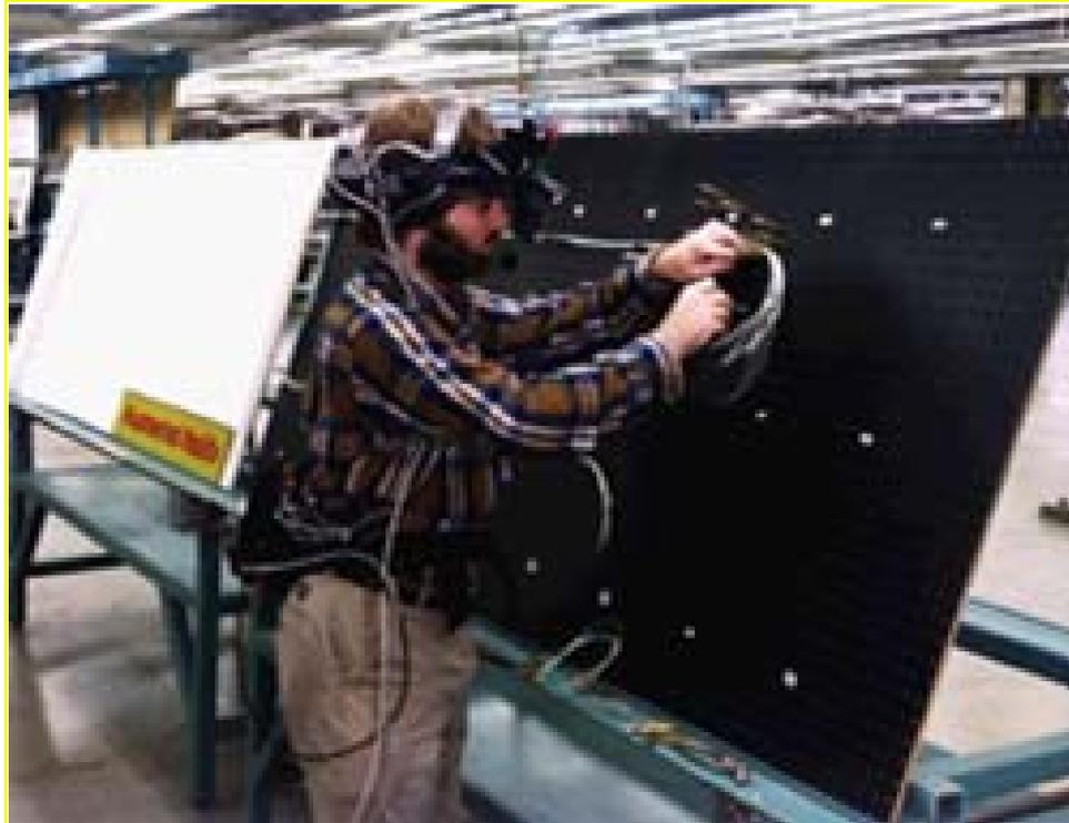
**Figura 1.1.2. Realtà aumentata nelle operazioni di cablaggio della Boeing**
