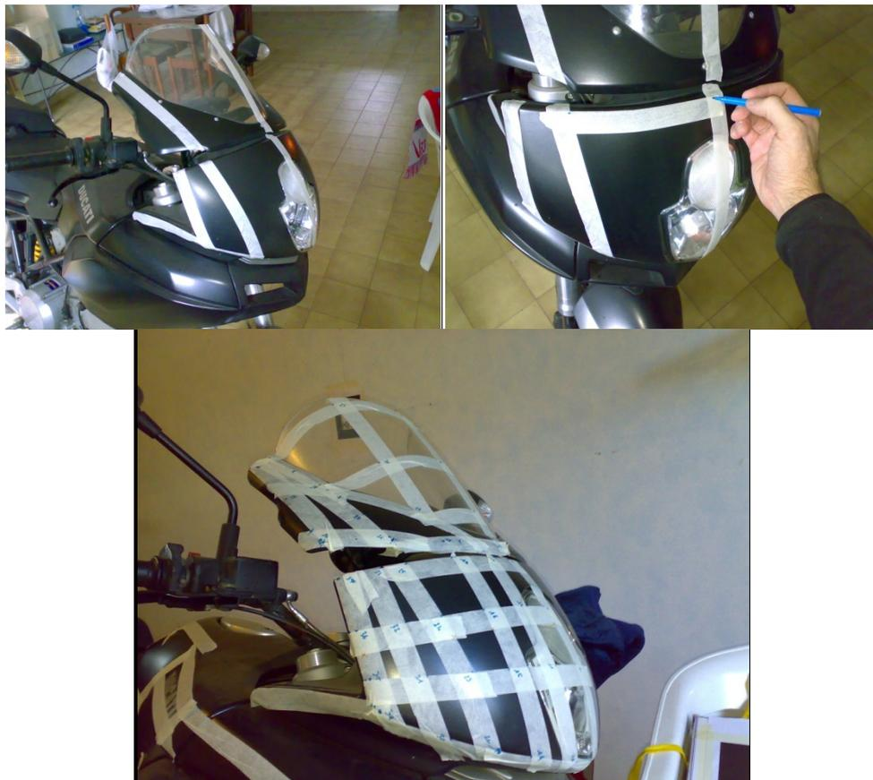
**Figura 3.3.11. Immagini della fase di preparazione: applicazione del nastro adesivo (in alto a sinistra), selezione dei punti appartenenti ai bordi (in alto a destra), risultato finale (in basso).**
