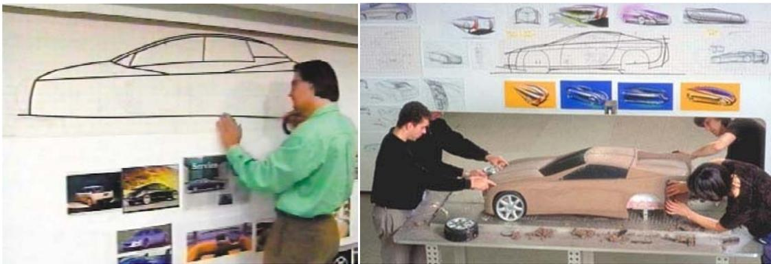
**Figura 3.2.2. Tecniche di prototipazione nel settore Automotive. A sinistra, il *Taping*. A Destra, la modellazione con sculture d'argilla.**
