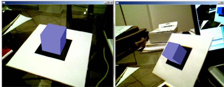
Figura 2.5.9. Applicazione AR per il disegno di un cubo virtuale.
