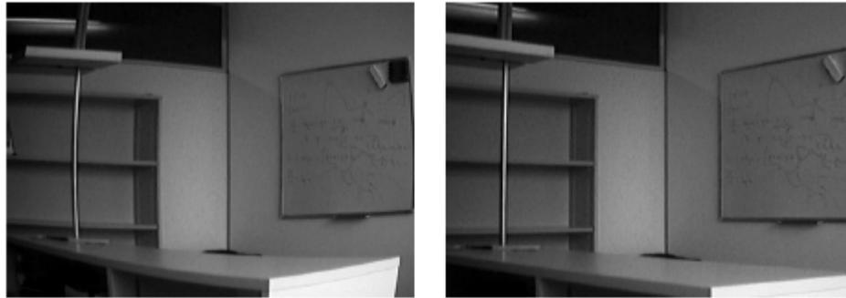
Figura 2.2.2. Il fenomeno della distorsione. Immagine distorta (a sinistra) immagine corretta (destra).
