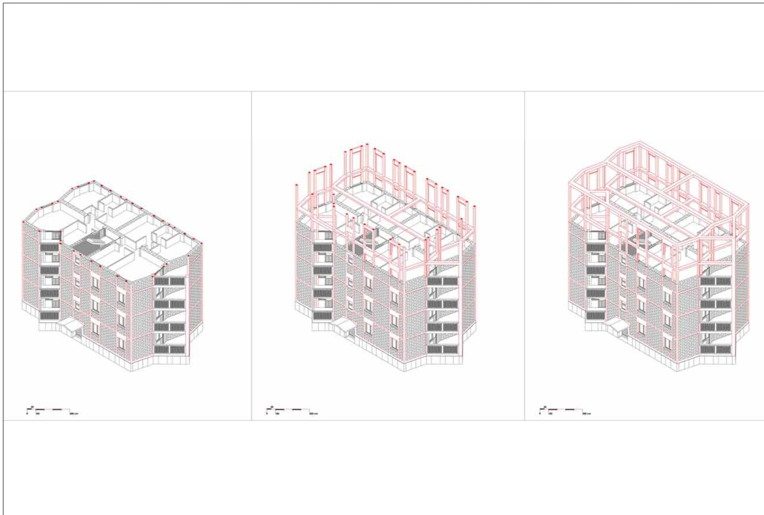
ANALISI COSTRUTTIVA DEGLI EDIFICI: LO SCHELETRO ANTISISMICO
