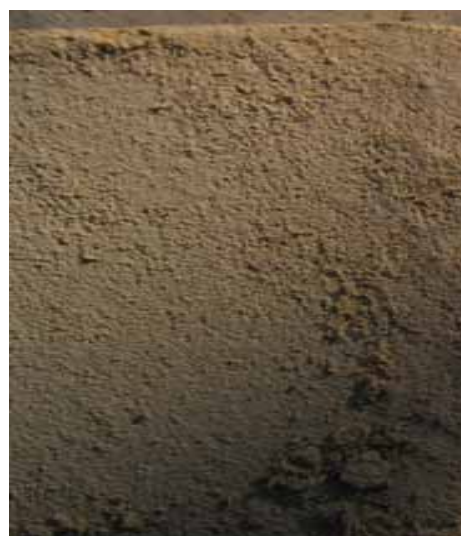
Figura 6: foto ravvicinata di un bloccodi tufo di Canosa delle cave di Cefalicchio e blocchi di tufo tagliati a misura
