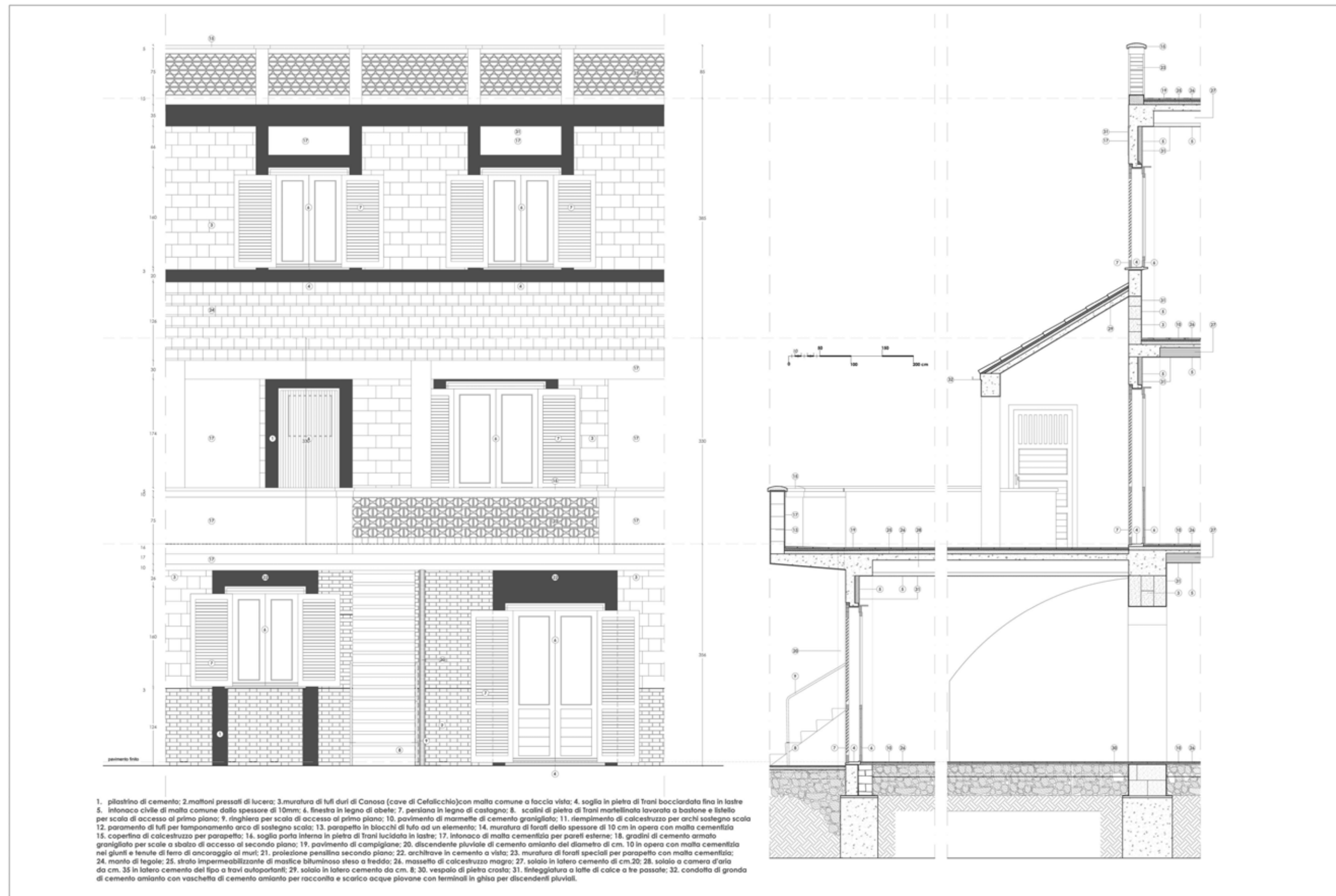
RICOSTRUZIONE DEI CARATTERI ORIGINALI: PROSPETTO E SEZIONE COSTRUTTIVA DEL TIPO D - E
