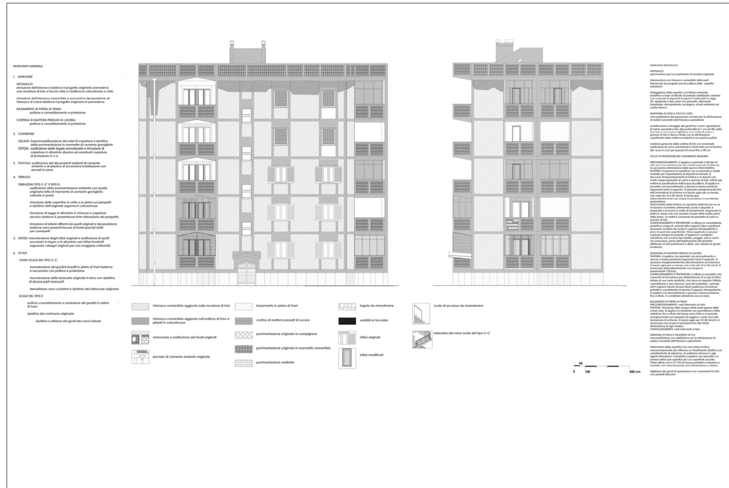
ANALISI DEL DEGRADO: PROSPETTI DELL'EDIFICIO C
