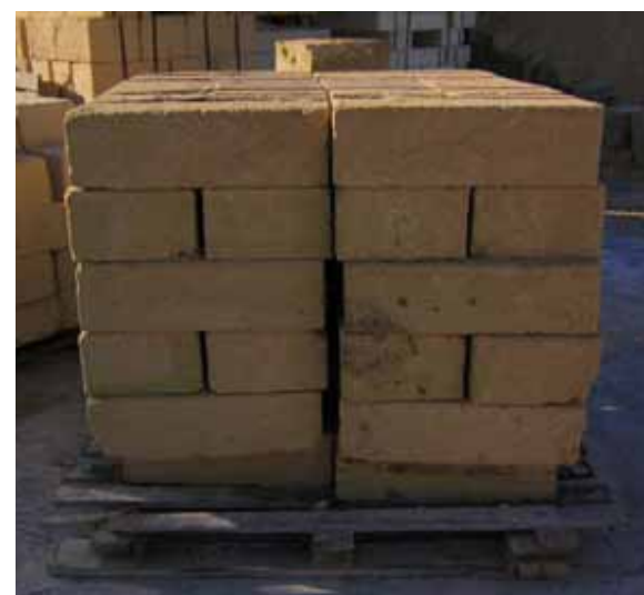
Figura 6: foto ravvicinata di un bloccodi tufo di Canosa delle cave di Cefalicchio e blocchi di tufo tagliati a misura
