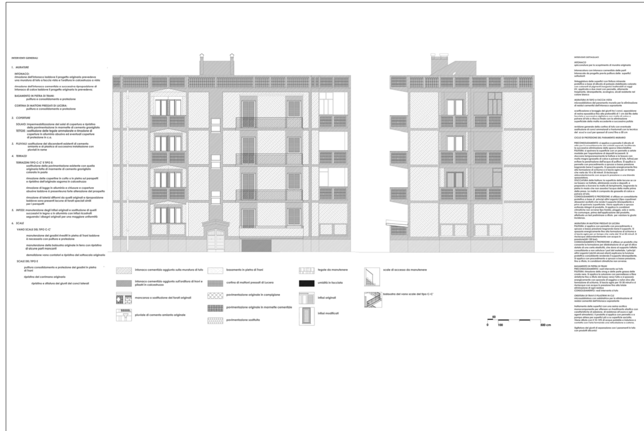
ANALISI DEL DEGRADO: PROSPETTI DELL'EDIFICIO C'
