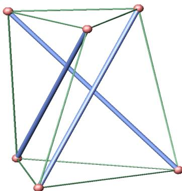
Figura 1.2: Un sistema tensintegro elementare.
