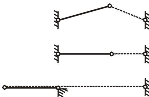
Figura 1.3: Arco a tre cerniere. L'elemento a tratto continuo ha lunghezza fissa, quello tratteggiato ha lunghezza variabile. Configurazione generica (in alto). Configurazione corrispondente alla lunghezza minima (al centro). Configurazione corrispondente alla lunghezza massima (in basso).
