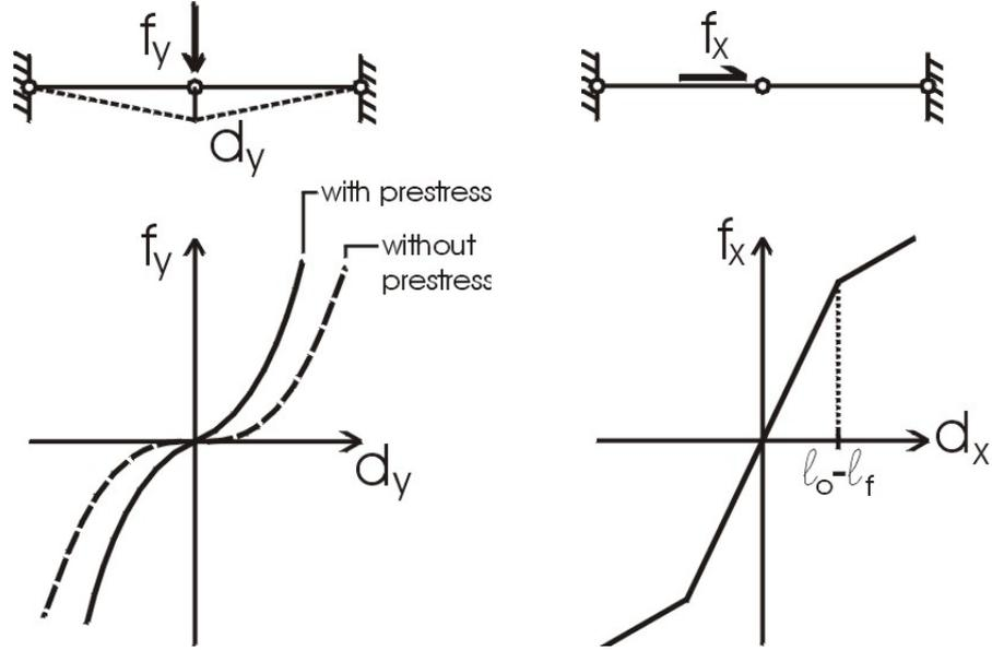
Figura 1.6: Statica. Carico ortogonale al meccanismo (a destra). Carico secondo il meccanismo (a sinistra).
