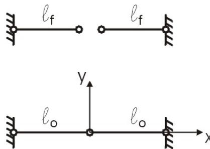
Figura 1.4: Meccanismo infinitesimo. Prima (in alto) e dopo (in basso) l'assemblaggio.
