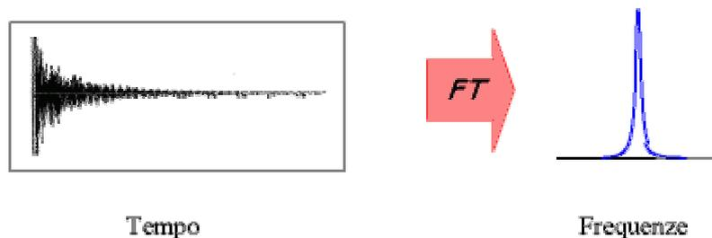
**Figura 1.6:** Conversione del segnale dal dominio dei tempi al dominio delle frequenze mediante la Trasformata di Fourier.
