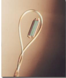
**Fig.9.12** Cristallo montato in un *loop* di nylon.
