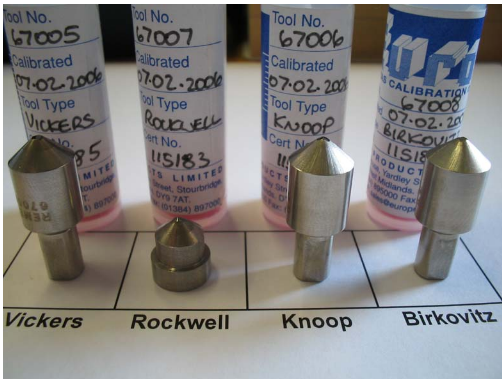
Figura_2.32 Penetratori, si noti il penetratore Rockwell modificato
