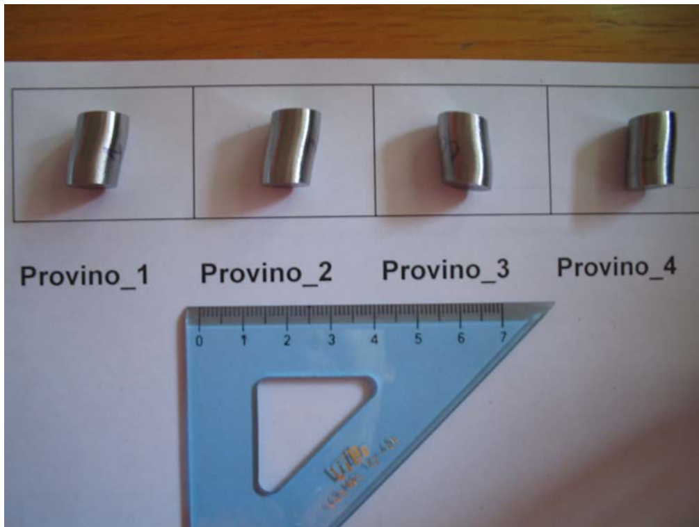
Figura_2.19 Campioni dell'acciaio F82H dopo la prova di compressione
