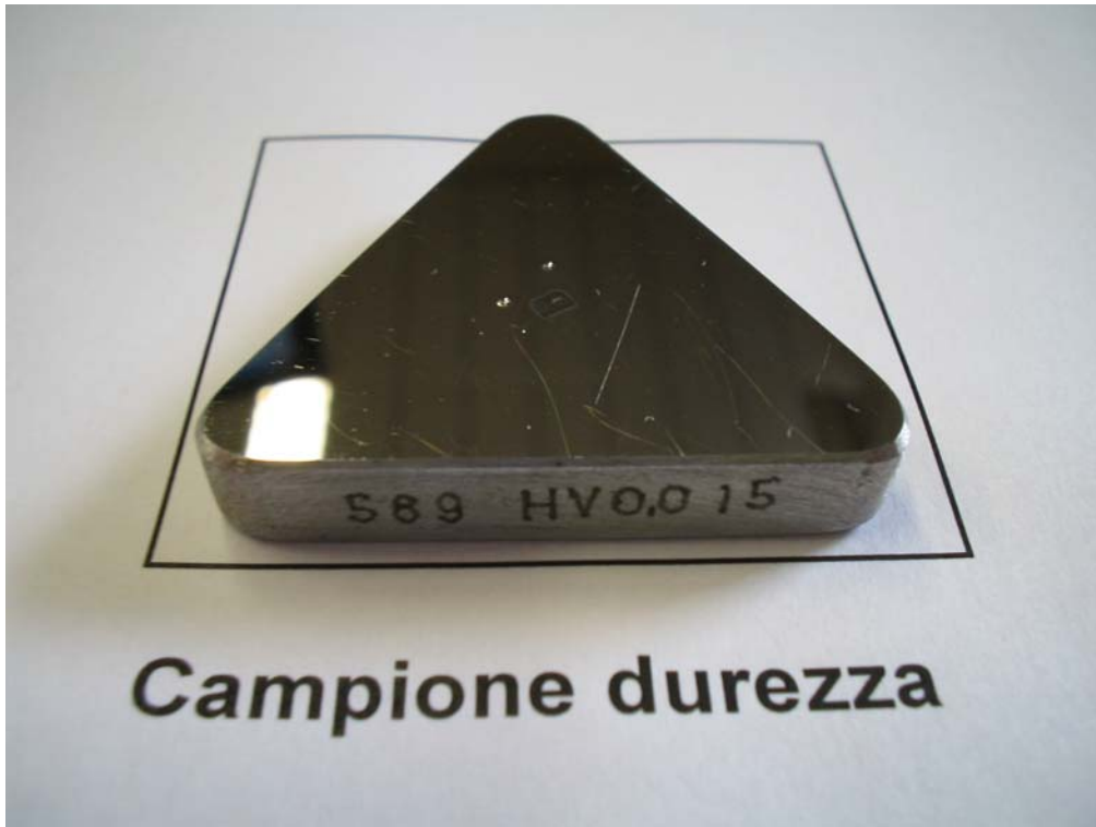
Figura_2.33 Campione di durezza nota
