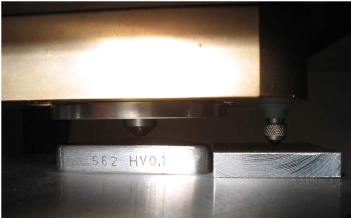
Figura_2.33 Campione di durezza nota
