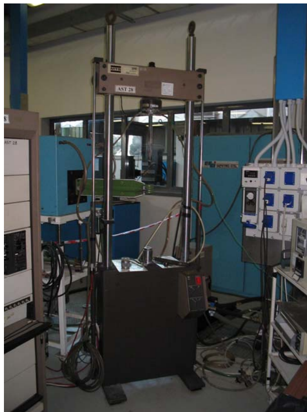
Figura_2.15 Macchina di compressione
