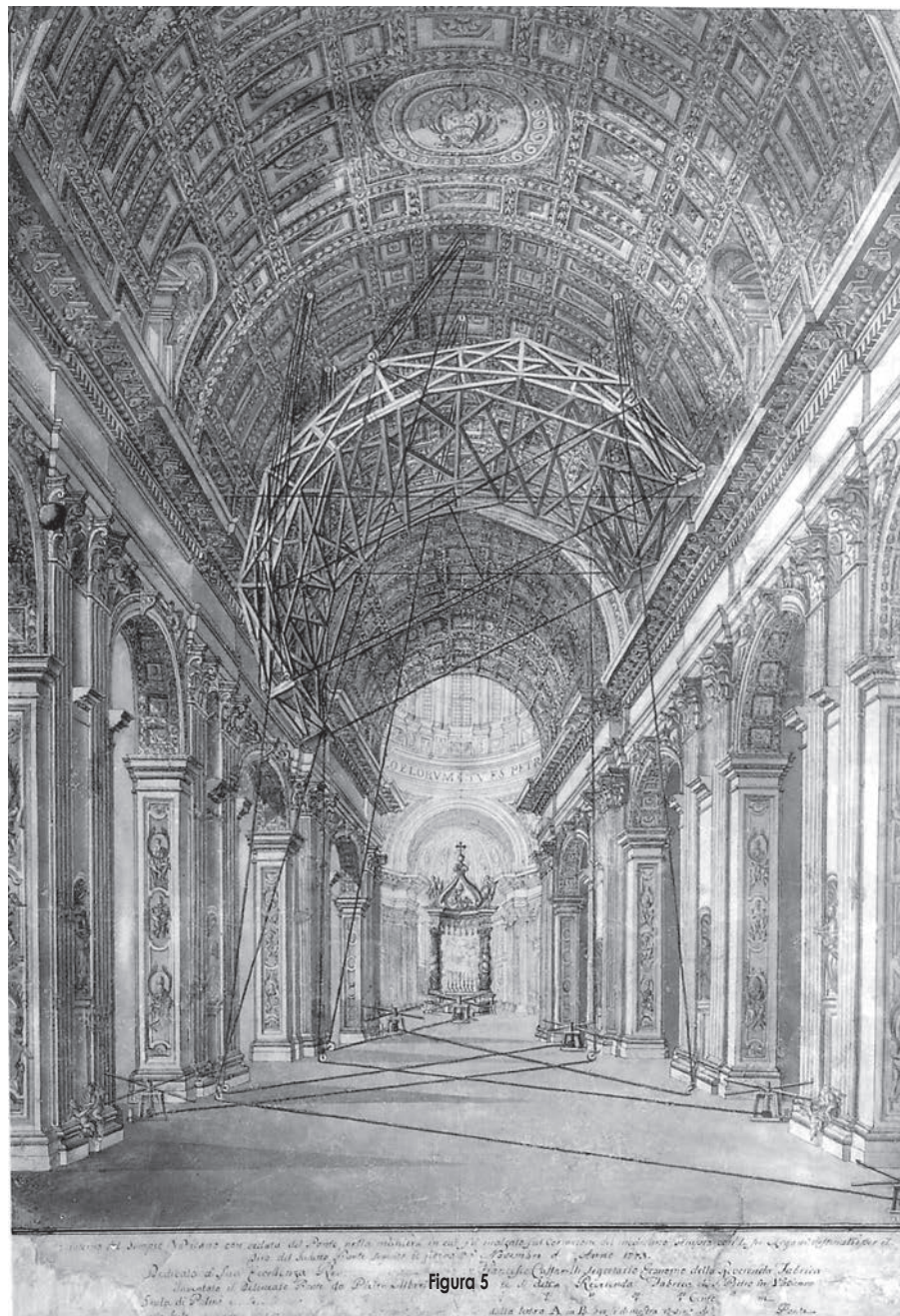
Figura 5 - Giacomo Sangermano, Installazione del ponteggio di Pietro Albertini sulla cornice della navata principale della Basilica di San Pietro, 1774, scala di palmi 100 romani, disegno preparatorio della tav. LIX di Castelli e Ponti 1824, Città del Vaticano. Si ringrazia per gentile concessione di questa immagine la Fabbrica di San Pietro in Vaticano.
