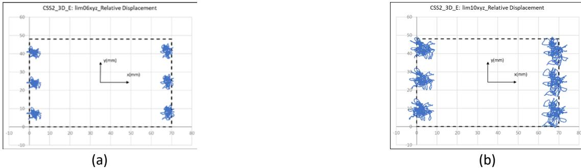
Figura 5.103: Spostamenti relativi massimi dei dispositivi di appoggio del sistema CSS2 per gli input (a) limxyz 06 e (b) limxyz 10.
