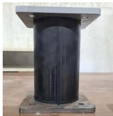
Figura 5.26: HDRB utilizzato per il sistema di isolamento.
