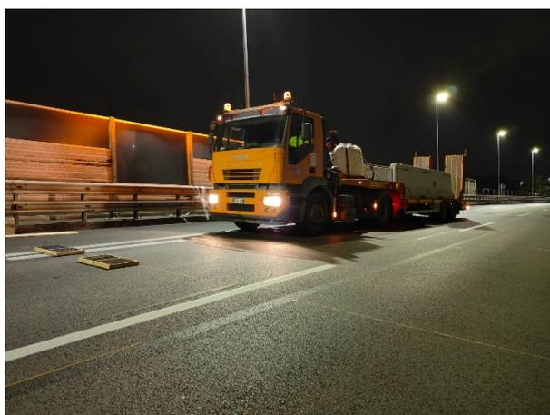
Figura 4.39: Veicolo utilizzato per le prove con passaggio del mezzo pesante.
