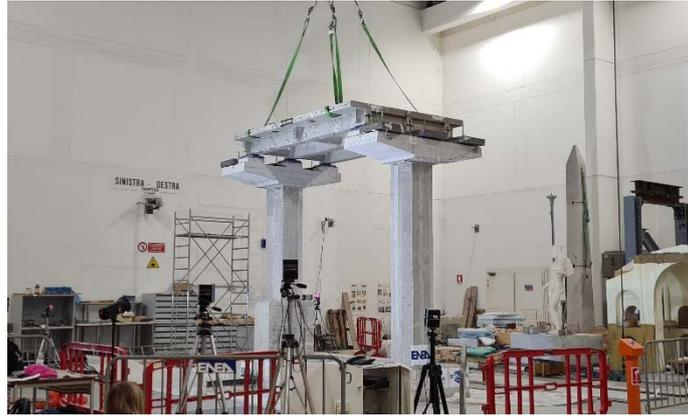
Figura 5.22: Prototipo in scala di una campata del viadotto Sordo.
