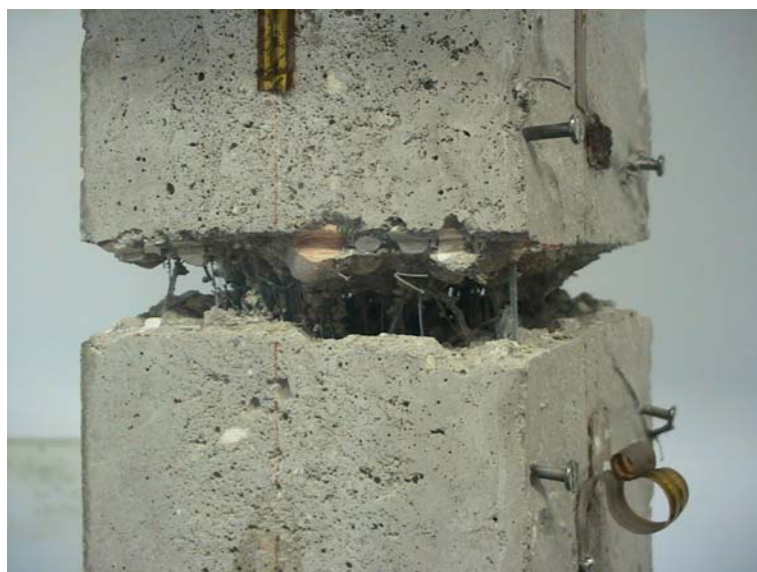
Figura 48 – Spostamenti al termine della prova di trazione
