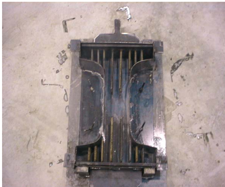
Figura 26 – Cassero di varo del provino pronto per il getto
