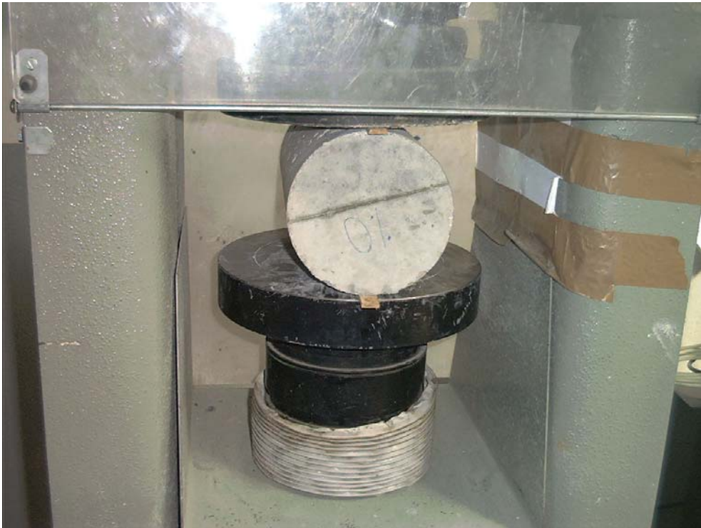
Figura 19 – Prova a trazione brasiliana
