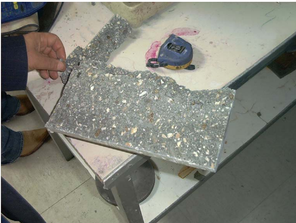
Figura 20 – Rottura del provino per prova a trazione brasiliana
