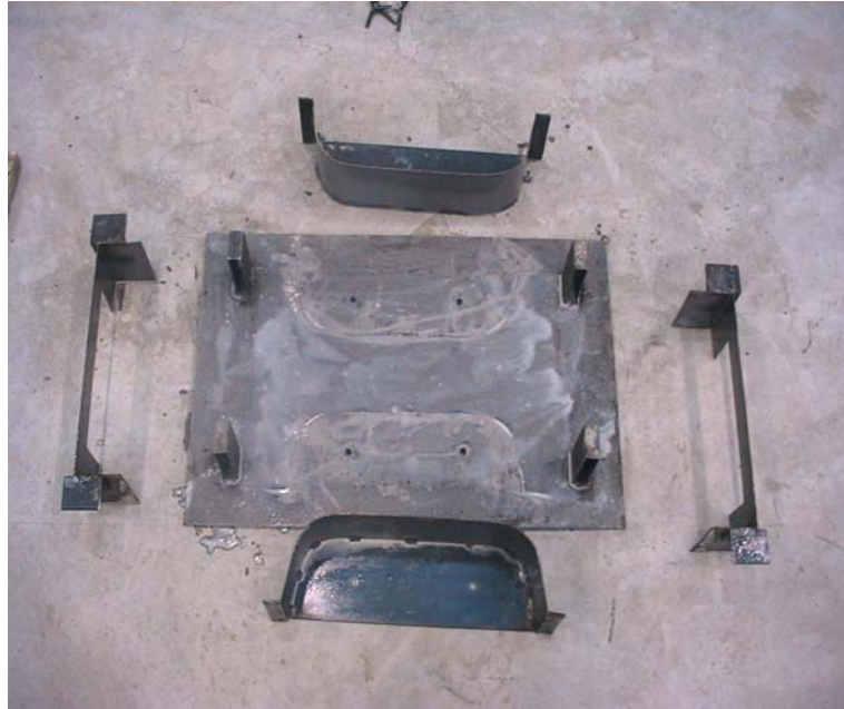
Figura 25 – Cassero di varo del provino aperto
