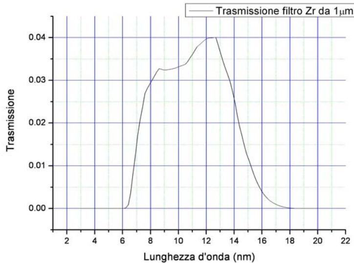
**Figura 36. Trasmissione spettrale del filtro di Zirconio utilizzato.**
