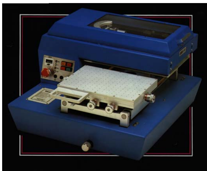
Figura P. La “High Performance Multi Purpose Screen Printer DEK 245”, macchina per la stampa serigrafica.
