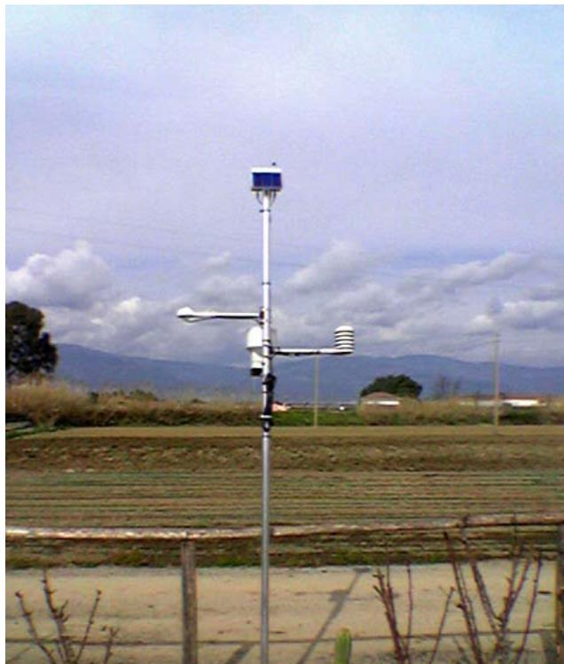
**Figura 2.6.1** - Stazione meteorologica di terra
