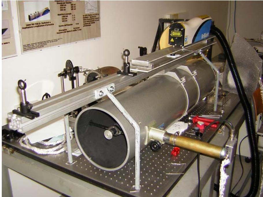
**Figura 2.1.5** - Configurazione del sistema di invio e ricezione della stazione mobile dimostrativa nel visibile
