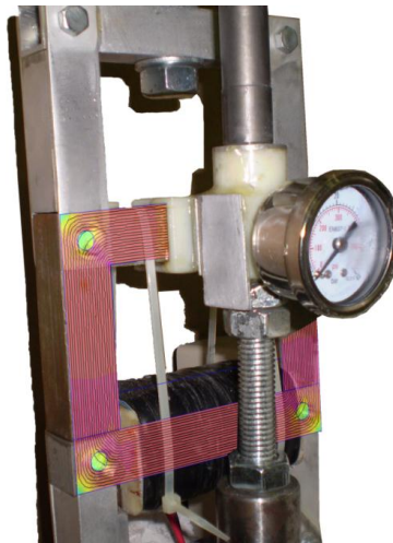
Figura 8: Magnetoreometro con contour del campo B sovrapposto
