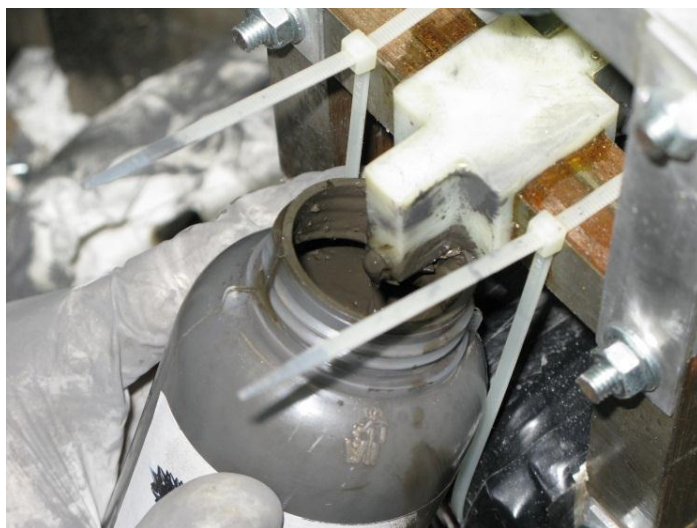
Figura 9: Efflusso di un fluido MR durante le prove
