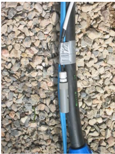
Figura 10-34 – Sensore di livello nei pozzi
