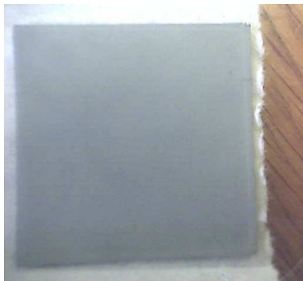
Figura 44: fotografia di un substrato 5 x 5 cm dopo processo di riduzione
