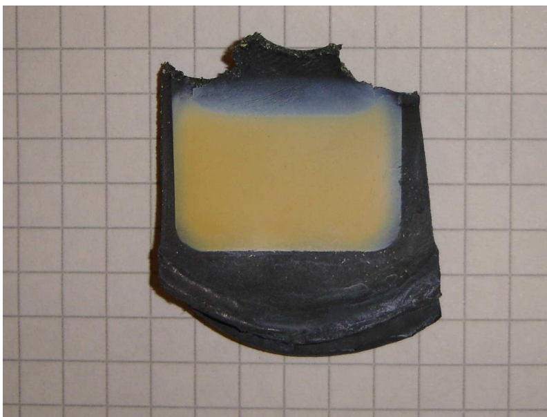
Figura 72: fotografia del verde del deposito di YSZ ottenuto per EPD in presenza di Tween80
