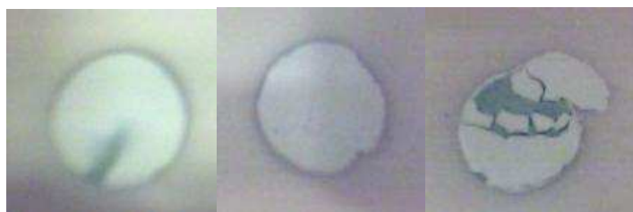
Figura 40: immagini relative alle deposizioni ottenute in un esperimento EPD imponendo una tensione pari a 50V per intervalli di tempo di 3, 5, 7 minuti
