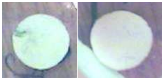
Figura 35: immagini relative ai depositi ottenuti imponendo 50 V e 60 V
