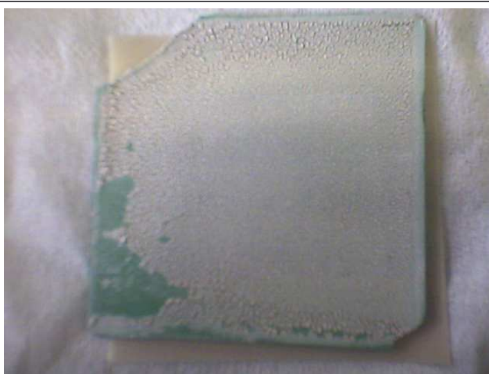
Figura 49: immagine di un campione 5 x 5 cm dopo EPD e sinterizzazione
