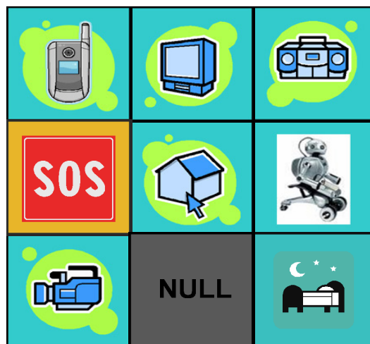
Figura 4.5: Menù principale: soltanto gli elementi “SOS” e “Null” inviano comandi diretti, gli altri servono ad accedere ai blocchi di comandi. Convenzionalmente lo sfondo azzurro è stato assegnato agli elementi che danno accesso ad un sottomenù, l’arancione a elementi di comando, il grigio a comandi nulli.
