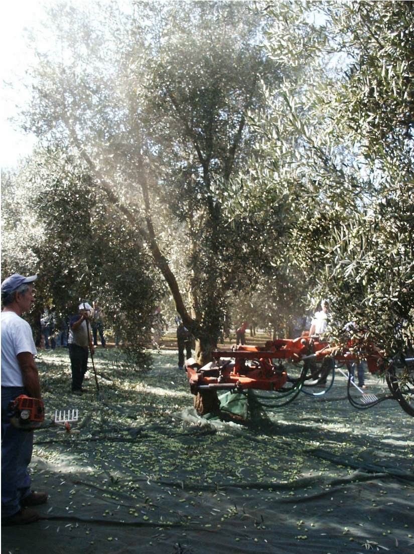
Foto 1 – Raccolta delle olive per scuotitura meccanica e reti
