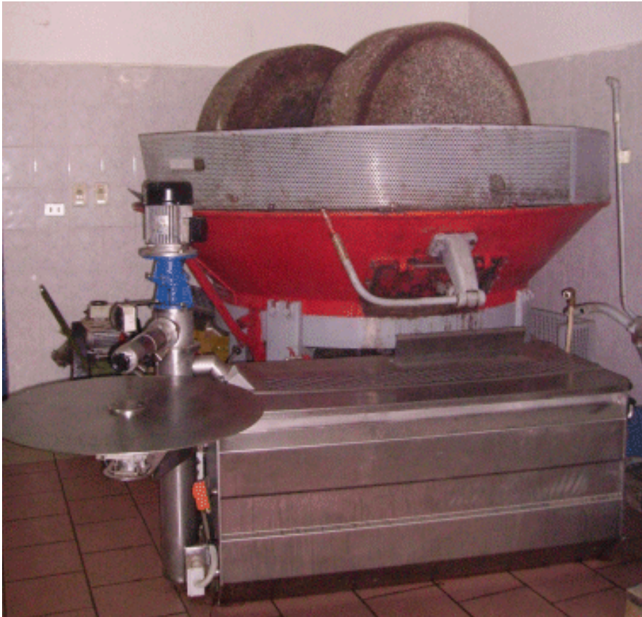
Foto 5 – Sistema di molitura con molazze e stratificatore della pasta
