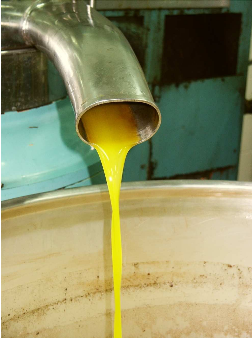
Foto 6 – Olio ottenuto per separazione centrifuga
