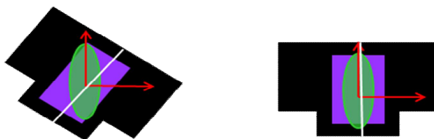
Figura 10 Posizione di sublimazione del campione (in viola) rispetto all'incidenza del fascio della RAS (in verde); a) e b) rappresentano rispettivamente la posizione di sublimazione e quella con l'angolo azimutale \theta=45^\circ dello spot luminoso rispetto al campione.
