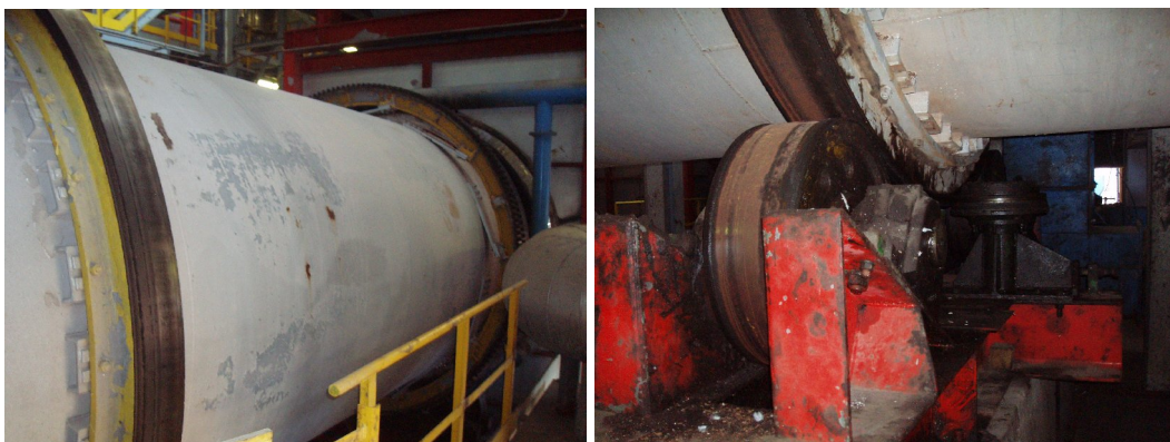
Figura 5.2: Vista laterale del tamburo rotante e dei cuscinetti di supporto
