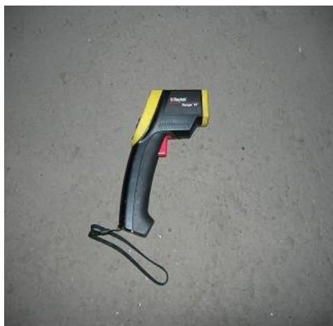
Figura 7.6: Sonda ad infrarossi per la rilevazione della temperatura superficiale
