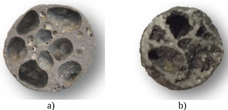
Fig. 4 – Effetto del tenore di TiH 2 sul processo di schiumatura (lega AlSi8 – SiC 9%): a) 0.4 %, b) 0.6%.
